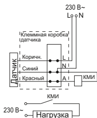
Рисунок 21 – Схема подключения датчика с контактором КМИ
