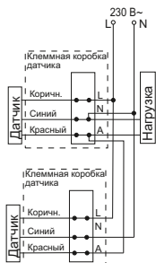
Рисунок 6 – Схема параллельного подключения датчиков движения
