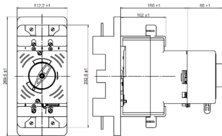
**Рисунок Б.11** - Выключатель BA57-35 с электромагнитным приводом на втычной панели
