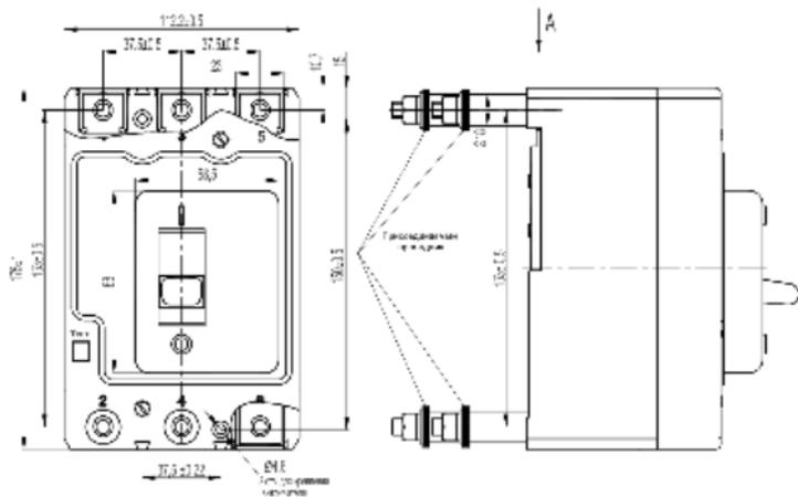
**Рисунок Б.2** - Выключатели BA57-35 (BA57Ф35) с зажимами для заднего присоединения
