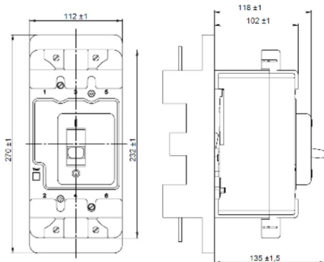
**Рисунок Б.10** - Выключатель BA57-35 на втычной панели
