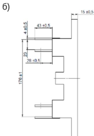
**Рисунок Б.9 - Панель втычная ВА57-35**
