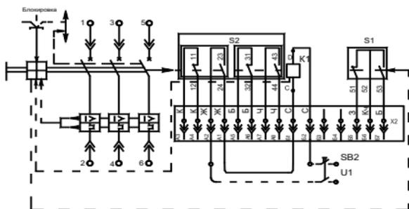
**Рисунок Г.6** - Схема электрическая принципиальная выключателей выдвигного исполнения, с независимым распределителем, вспомогательными контактами, вспомогательными контактами сигнализации автоматического отключения
