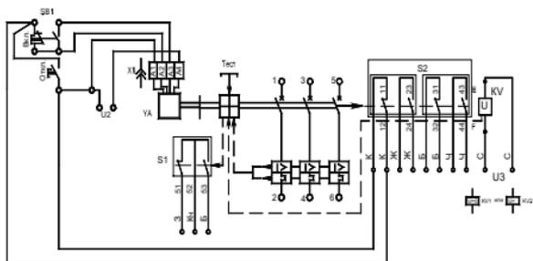
**Рисунок Г.4** - Схема электрическая принципиальная выключателей стационарного исполнения, с нулевым или минимальным распределителем напряжения, вспомогательными контактами сигнализации автоматического отключения, вспомогательными контактами и электромагнитным приводом
