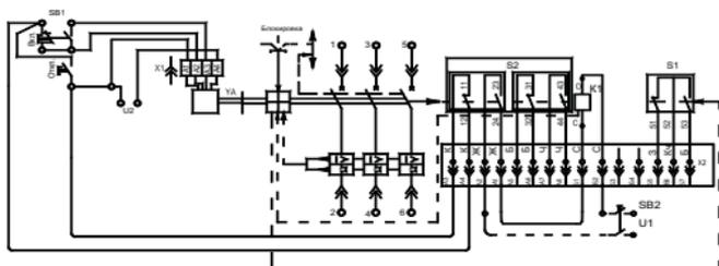
**Рисунок Г.5** - Схема электрическая принципиальная выключателей выдвигного исполнения, с независимым распределителем, вспомогательными контактами, вспомогательными контактами сигнализации автоматического отключения и электромагнитным приводом
