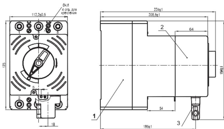
1 - выключатель; 2 - привод электромагнитный; 3 - соединитель типа РП10
