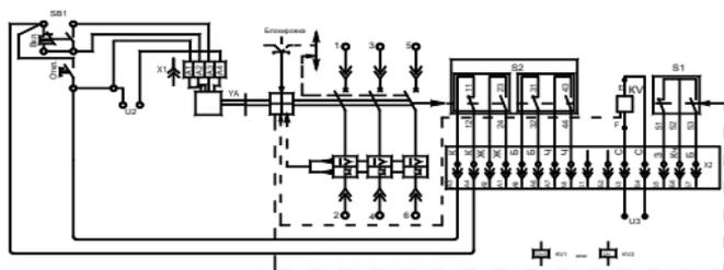
**Рисунок Г.7** - Схема электрическая принципиальная выключателей выдвижного исполнения, с нулевым или минимальным расцепителем напряжения, вспомогательными контактами сигнализации автоматического отключения, вспомогательными контактами и электромагнитным приводом
