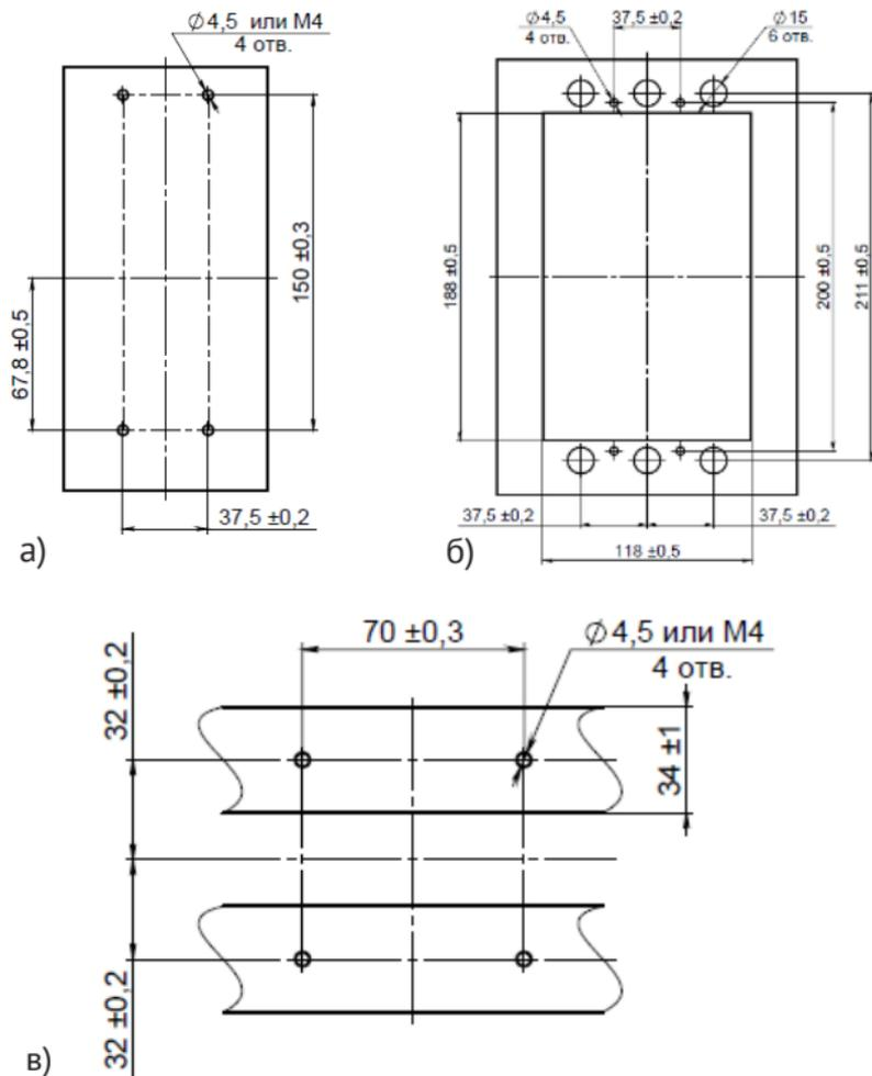
**Рисунок Б.12** - Расположение отверстий для крепления втычной панели
