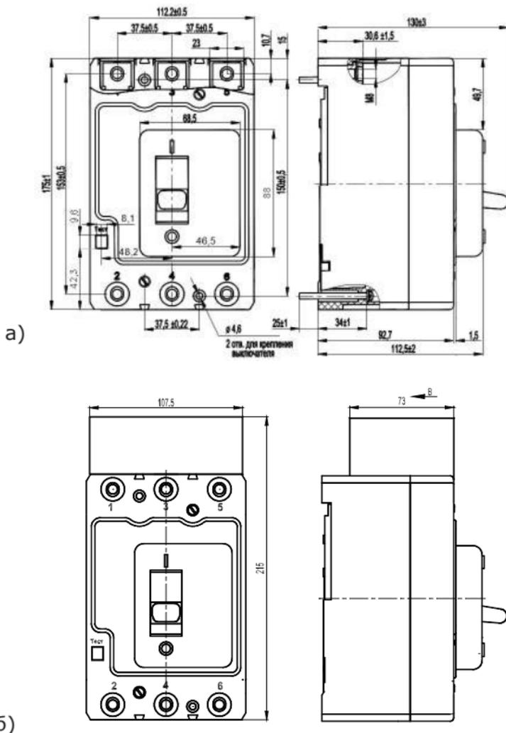
**Рисунок Б.1** - Выключатель BA57-35 (BA57Ф35) с зажимами для переднего присоединения
