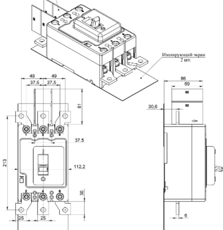
**Рисунок Д.2** – Присоединение с расширительными выводами, межполюсными перегородками и изолирующими экранами
