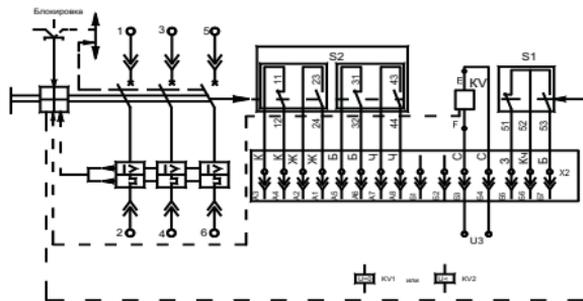
**Рисунок Г.8** - Схема электрическая принципиальная выключателей выдвижного исполнения, с нулевым или минимальным расцепителем напряжения, вспомогательными контактами сигнализации автоматического отключения, вспомогательными контактами
