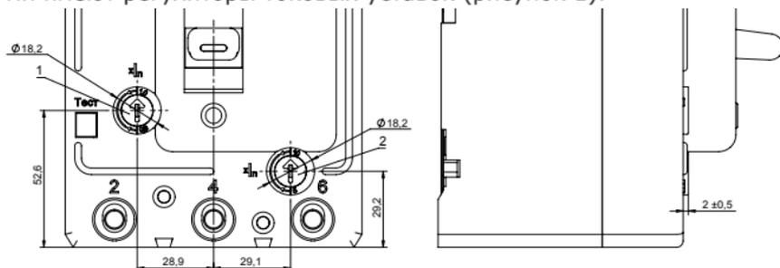
Рисунок 1 – Выключатель с регулируемыми максимальными расцепителями .
