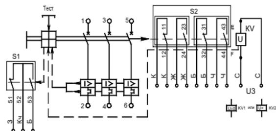
**Рисунок Г.3** - Схема электрическая принципиальная выключателей стационарного исполнения, с нулевым или минимальным расцепителем напряжения, вспомогательными контактами сигнализации автоматического отключения и вспомогательными контактами
