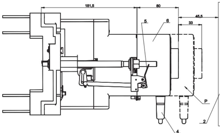
1 - выключатель; 2 - дверь распределительного устройства; 3 - привод ручной дистанционный; 4 - соединитель типа РП10; 5 - блокировка; 6 - привод электромагнитный;
