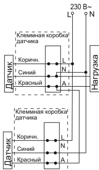
Рисунок 19 – Схема параллельного подключения датчиков
