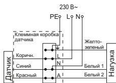
Рисунок 18 – Схема подключения датчиков ДД 017, ДД 019
