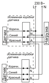
Рисунок 6 – Схема параллельного подключения датчиков движения
