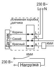
Рисунок 8 – Схема подключения датчиков с контактором КМИ
