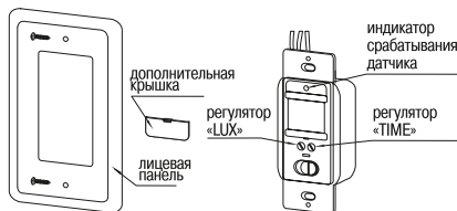
Рисунок 11 – Конструкция датчика движения ДД-028
