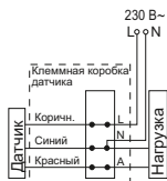
Рисунок 17 – Схема подключения датчиков ДД 008, ДД 009, ДД 010, ДД 012, ДД 018В
