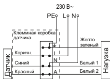
Рисунок 18 – Схема подключения датчиков ДД 017, ДД 019
