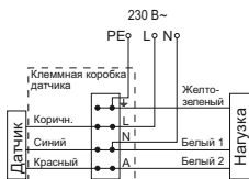
Рисунок 18 – Схема подключения датчиков ДД 017, ДД 019
