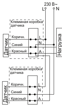
Рисунок 19 – Схема параллельного подключения датчиков
