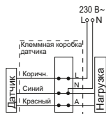
Рисунок 17 – Схема подключения датчиков ДД 008, ДД 009, ДД 010, ДД 012, ДД 018В
