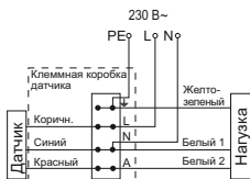
Рисунок 18 – Схема подключения датчиков ДД 017, ДД 019
