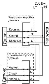
Рисунок 19 – Схема параллельного подключения датчиков
