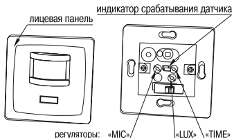
Рисунок 15 – Конструкция датчика движения ДД-035
